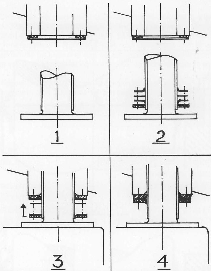
**1.** Mellom festering og hylseboks/dekksplate må det alltid ligge pakning eller tetningstoff. (Lages/leveres av verksted/verft) Dersom boksen sveises fast, bortfaller pakning. Festeringen sentreres i forhold til rorstammen og skrues fast med de medleverte forsenkede unbrakoskruene.
